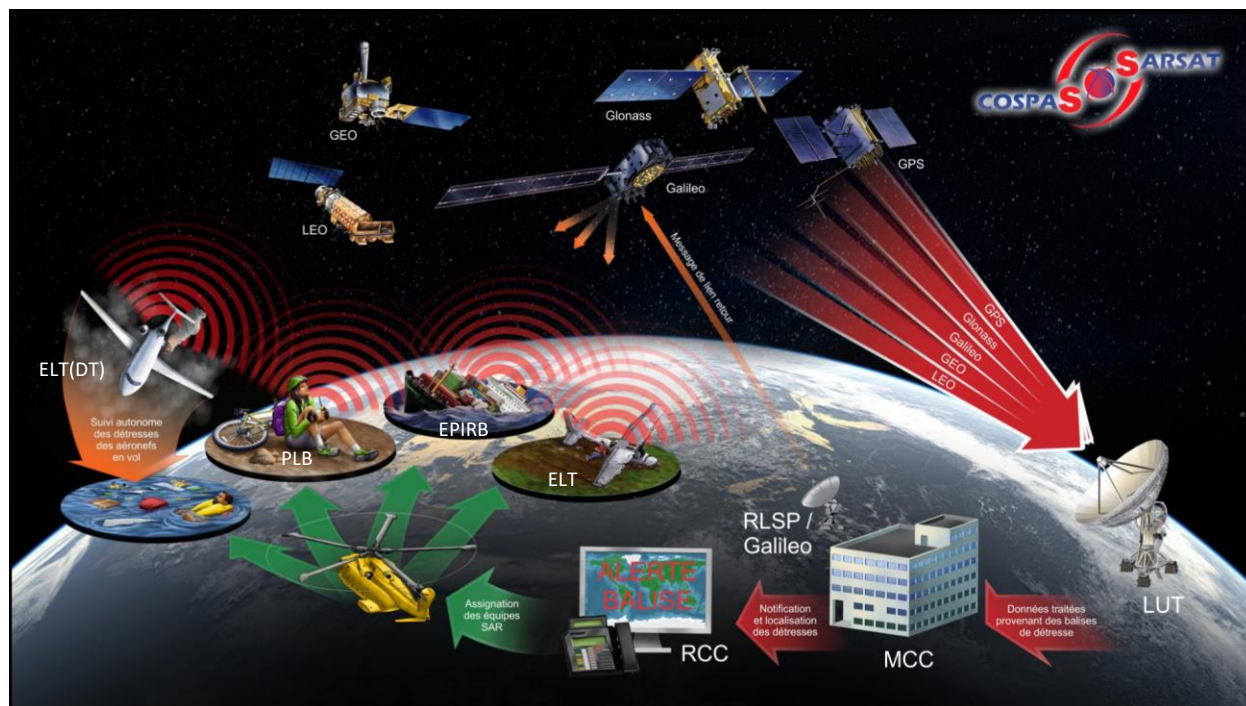
Figure 8 : Aperçu du Système Cospas-Sarsat
