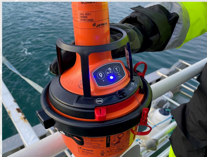
Une EPIRB 406 MHz avec capacité RLS. Certains modèles sont de la taille d'une simple bouteille.
